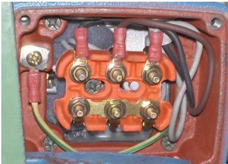
La sezione dei conduttori è in funzione della protezione a monte (a carico del cliente). Valutando la necessità di installazione di una protezione magnetotermica di 2 A la
