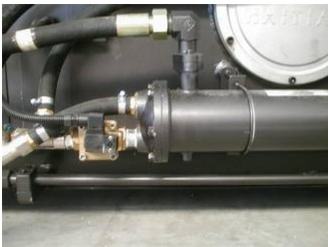
Collegamento con lo scambiatore di calore. Il circuito prevede una connessione in ingresso (parte bassa dello scambiatore) e una connessione in uscita (parte alta dello scambiatore). Porre particolare attenzione alla posizione delle connessioni perché se l'ingresso del fluido non avviene dal basso verso l'alto è possibile la formazione di sacche di aria con la relativa inefficienza del sistema di raffreddamento.
