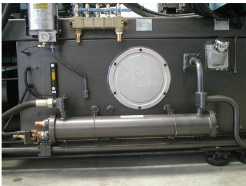
Il sistema rileva la temperatura del fluido attraverso la sonda TCOL (pag 32 dello schema idraulico). Al raggiungimento del valore di SET (capitolo 7.4.3.3 PAGINA 02 – RISCALDAMENTI) interviene il solenoide 20YV3 che permette la circolazione dell'acqua di raffreddamento nello scambiatore di calore.
