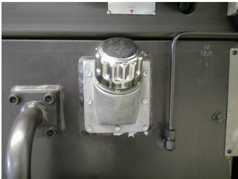
Sul lato opposto operatore, sotto il motore oleodinamico per la rotazione della vite, è fissato il rilevatore di livello dell'olio munito di galleggiante.
