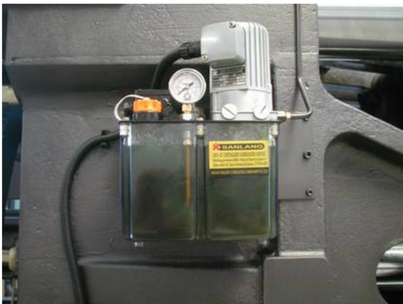
Sistema di lubrificazione centralizzata
