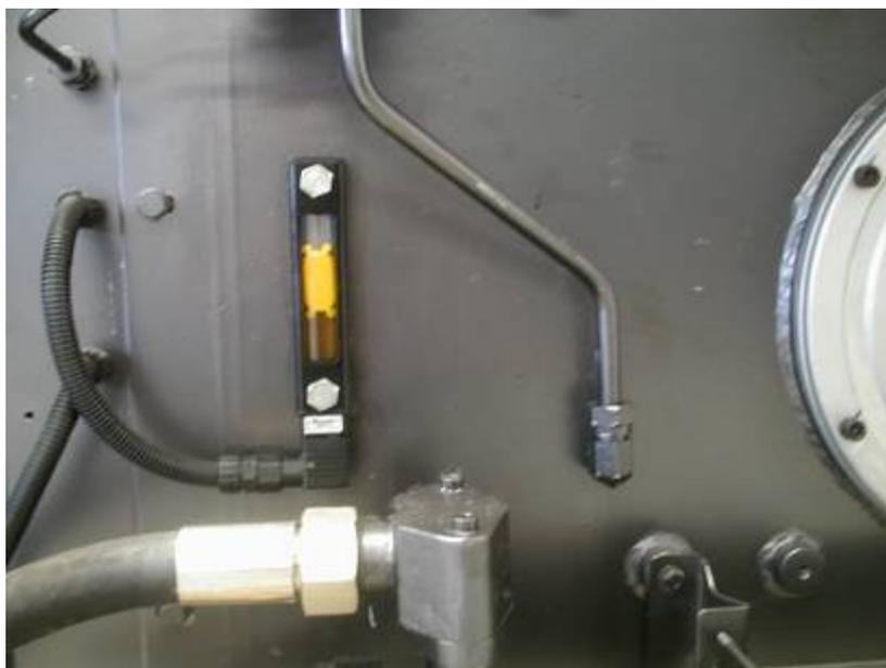
E' da tenere presente che il circuito idraulico della pressa è completamente vuoto quindi, all'avviamento del motore pompa, si verificherà necessariamente un calo del livello.
