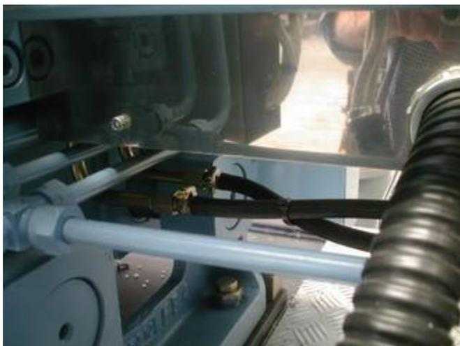
Esempio di connessione con il cilindro iniezione. La posizione delle tubazioni di entrata e di uscita è indifferente.
