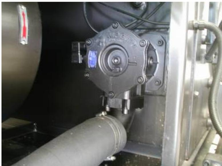
E' necessario svitare la vite centrale prima di asportare quelle esterne: l'operazione chiude una saracinesca che impedisce la fuoriuscita dell'olio dal serbatoio durante l'asportazione del filtro.
