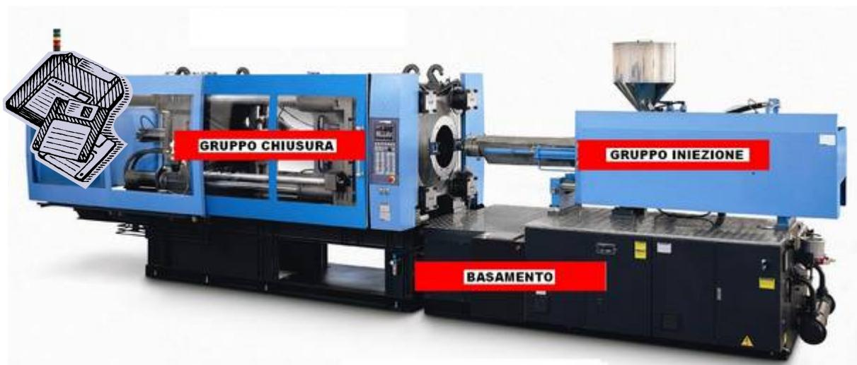
La macchina è dotata di un impianto oleodinamico incorporato ed di una apparecchiatura elettronica che consente un funzionamento con ciclo manuale, semiautomatico o automatico.
