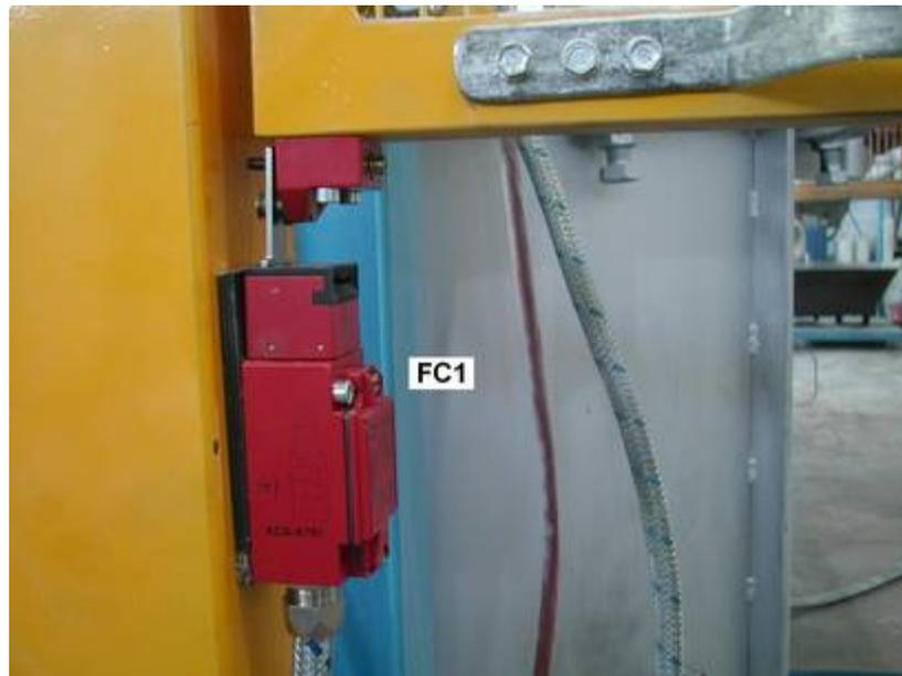
Due contatti normalmente chiusi agiscono sul modulo di sicurezza SICK UE 43 2MF202 e, in caso di apertura, arrestano immediatamente il funzionamento del motore pompa idraulica.
